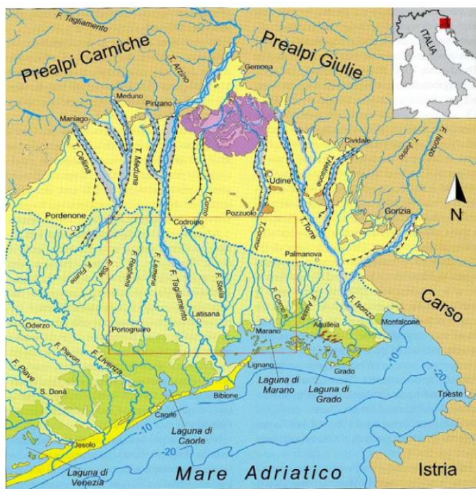
Fig. 3 - Le unità fisiografiche della Pianura Friulana e veneta orientale. 1. idrografia - 2. Orlo delle principali scarpate fluviali - 3. Limite superiore delle risorgive - 4. Isobate - 7. Rilievi prealpini - 8,9. Anfiteatro morenico del Tagliamento - 10. Alta pianura - 11. Bassa pianura - 12. Zone poste sotto il livello marino - 13. Greti fluviali - 14. Sistemi costieri e deltizi - 15. Terrazzi tettonici - 16. Antichi rilievi sabbiosi della zona di Aquileia (Fontana 2006)
